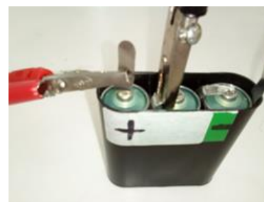
Εδώ, έχουμε επιλέξει ένα από τα τρία ηλεκτρικά στοιχεία που περιέχει η μπαταρία των «4,5V»
